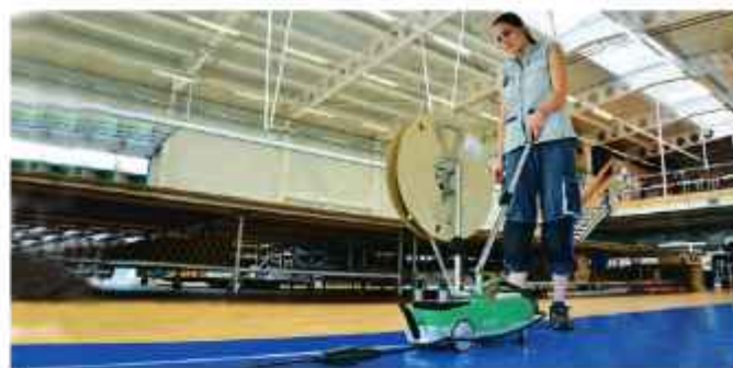
Úsporný, ergonomický přístroj pro navařování zesilovacích pásů.
