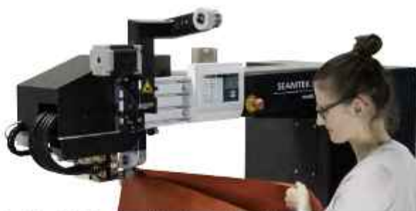
Svařování nízkonapětovým horkým klínem
