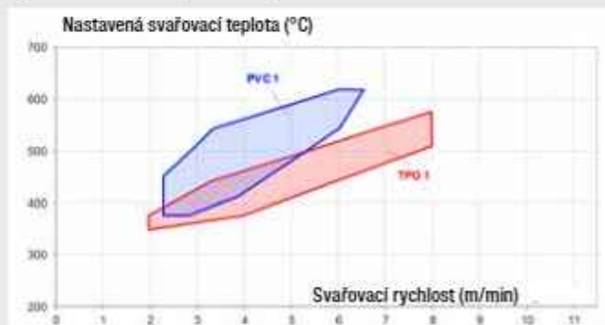
Typické svařovací okno pro TPO a PVC
