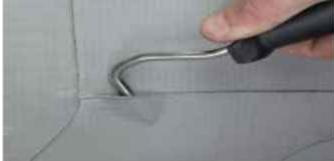
Zkouška svaru zkušebním háčkem.
