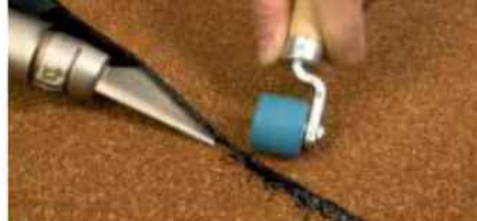
TRIAC se speciální tryskou pro svařování bitumenu.
